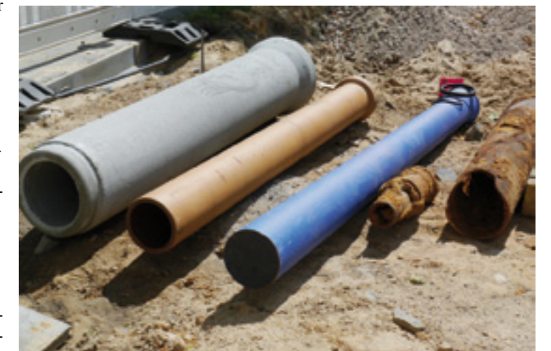
v. li. Regenwasserrohr, Rohr für Schmutzwasser, die neue Trinkwasserleitung aus Gusseisen und die alte in die Jahre gekommene Trinkwasserleitung Foto: Katja Lützelberger
